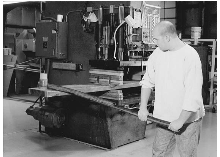
FIG. 26 Aplique fuerza hacia abajo cuidadosamente para producir una torcedura en el enfriador
